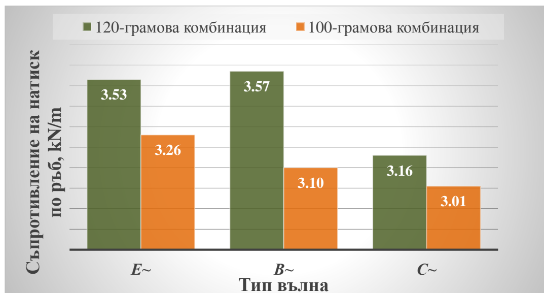
Фиг. 4 Сравнителна характеристика на показателя ECT за изследваните комбинации вълнообразен картон
