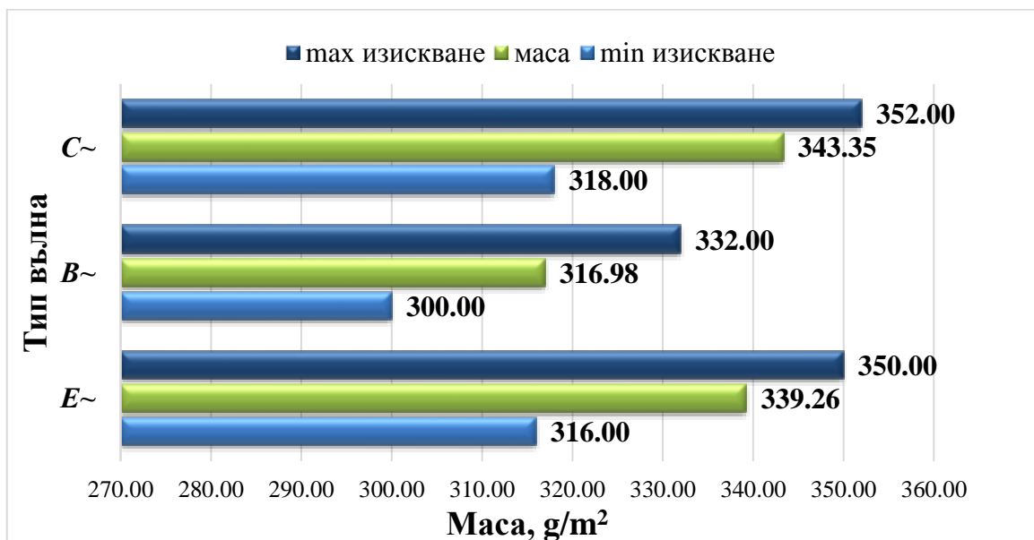
Фиг. 1 Сравнителна характеристика на показателя маса за комбинациите вълнообразен картон със 100-грамов пласт
