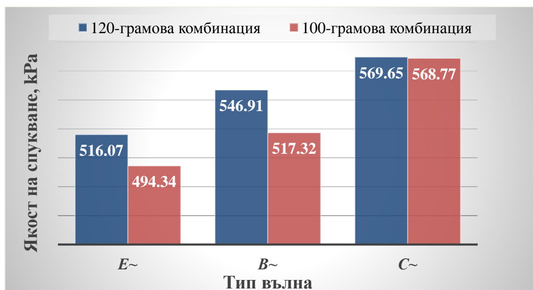
Фиг. 3 Сравнителна характеристика на показателя BST за изследваните комбинации вълнообразен картон
